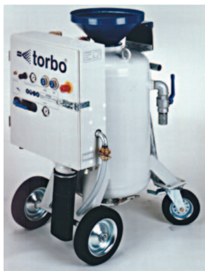
torbo® L torbo® JUNIOR Váha: 180 kg Rozměry: 1.220x830x660 mm Zásobník abraziva: 120 l Přípoj tlakového vzduchu: 6/4" Dávkování tryskací směsi: 0,6–8 l/min *) Násypka: S95
