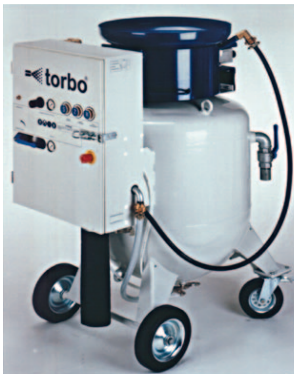
torbo® XLS torbo® 320 Váha: 360 kg Rozměry: 1.490x1.260x750 mm Zásobník abraziva: 320 l Přípoj tlakového vzduchu: 2" Dávkování tryskací směsi: 0,6–8 l/min *) Násypka: FS95
