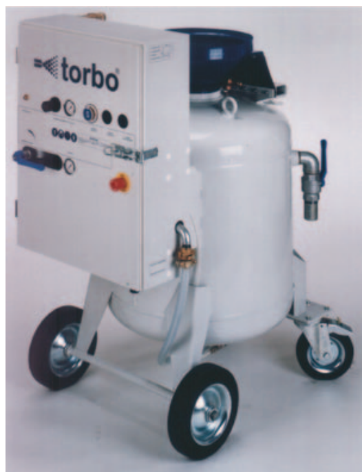
torbo® XL torbo® 240 Váha: 330 kg Rozměry: 1.36000x1.100x750 mm Zásobník abraziva: 200 l Přípoj tlakového vzduchu: 2" Dávkování tryskací směsi: 0,6–8 l/min *) Násypka: S95
